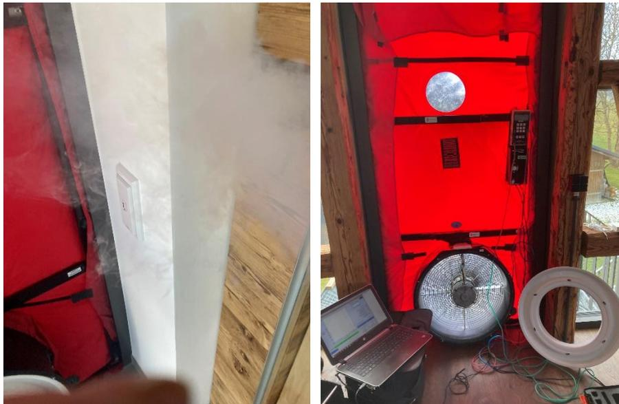
Abb. 25: Beispiel Blower Door Prüfung
